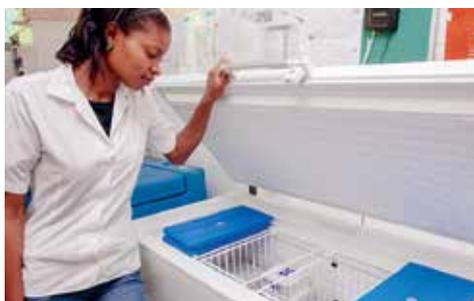
Un agent de santé inspecte un réfrigérateur contrôlé à l'aide de ColdTrace Analytics, technologie sans fil qui permet de transmettre à distance les données fournies par des capteurs de température.
